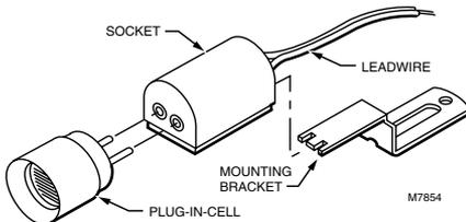
Fig. 1. C554A Cadmium Sulfide Flame Detector (cad cell).
