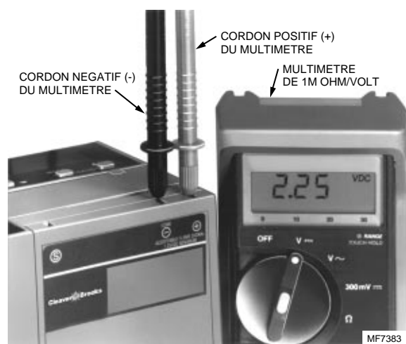
Fig. 22. Mesure du signal de flamme.
