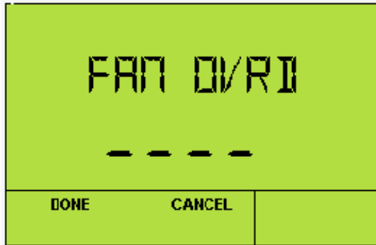
Figure 35: Parameter Override Fan OvrD
